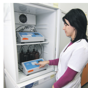
Stația de epurare: incubator pentru determinarea consumului biochimic de oxigen, unul dintre echipamente cu care a fost dotat laboratorul stației
