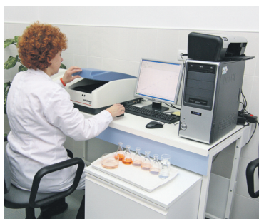
Stația de la Mărtinești: spectrofotometru, unul dintre echipamente cu care a fost dotat laboratorul stației
